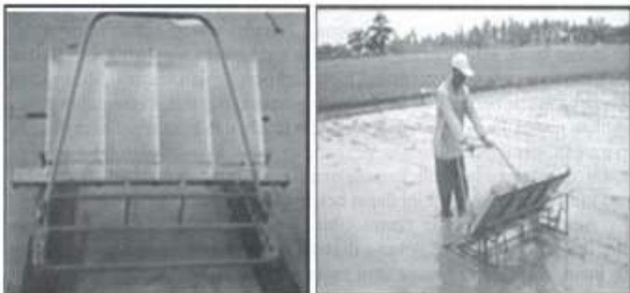
**Gambar 5.4.** (a) Alat tanam bibit manual, dan (b) operator yang menggunakan alat tanam bibit manual
