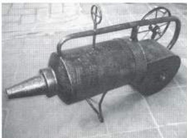
Gambar 7.6. Alat pengempos tikus terbuat dari pipa galvanized
