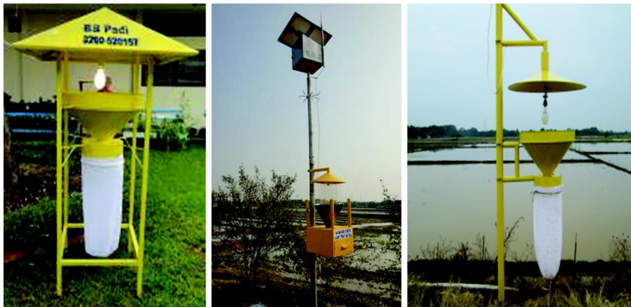
Lampu perangkap model BSE-G3 (kiri), lampu perangkap solar cell (tengah), dan lampu perangkap model BSE-G4 (kanan) untuk memantau hama tanaman padi.
