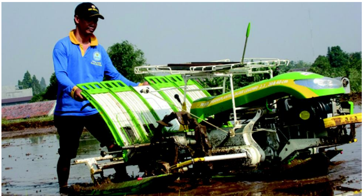
Mesin tanam padi Indo Jarwo Transplanter mempercepat waktu tanam dan menurunkan biaya tanam.
