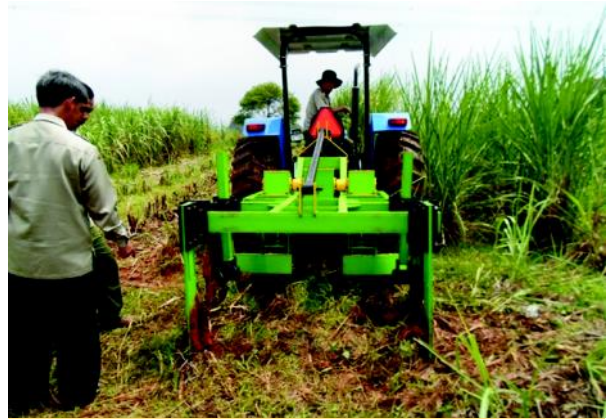
Prototipe alsin kepras tebu tipe juring ganda saat dioperasikan.
