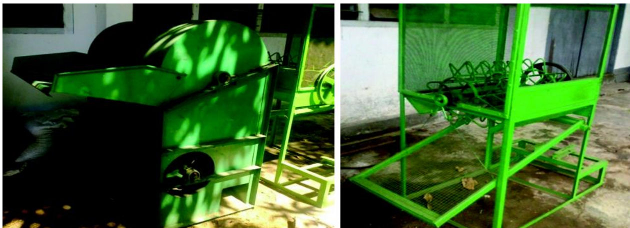
Prototipe mesin perontok biji gandum tipe potong atas PG-M1-Balitsereal (kiri) dan tipe potong bawah PG-M2-Balitsereal.
