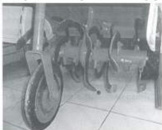
Gambar 4.9. Pisau berputar ( Rotari plow )
