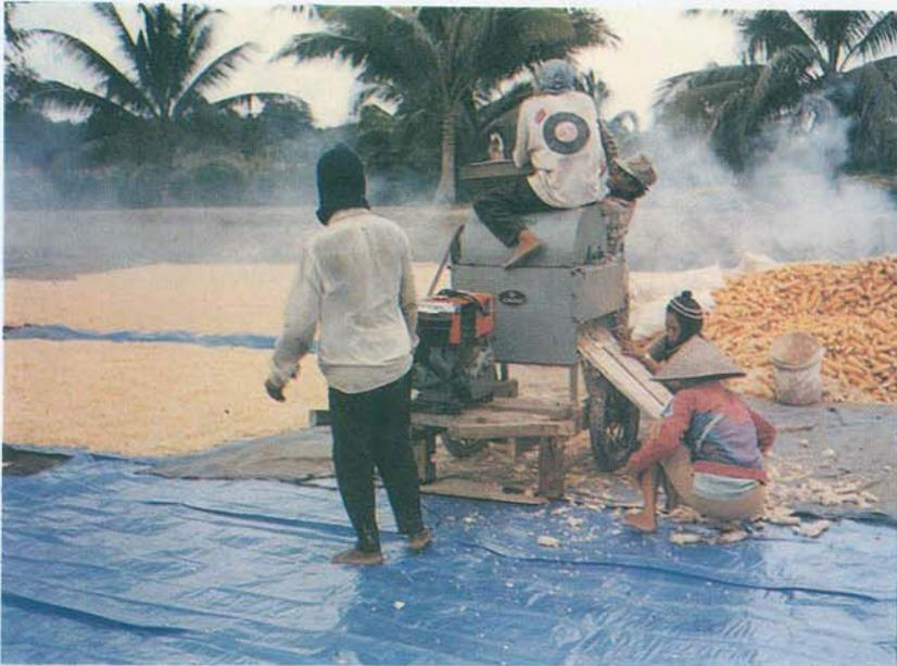
*Penggunaan alat dan mesin pemipil dalam pemipilan jagung dapat mempercepat proses pemipilan, mengatasi kekurangan tenaga kerja, dan perlu dikembangkan dalam mewujudkan sistem produksi yang modern.*
