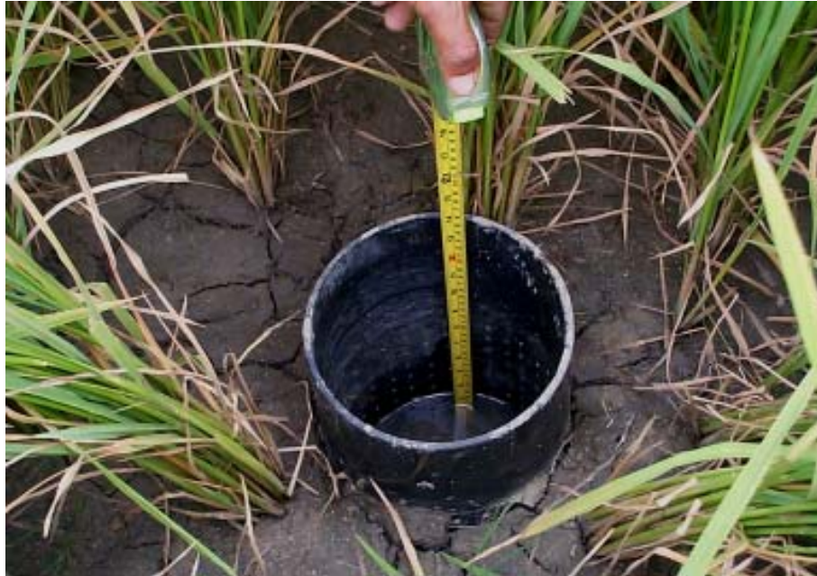
Paralon berlubang merupakan alat sederhana untuk mengukur ketersediaan air di permukaan lahan dalam upaya efisiensi pemakaian air pada tanaman padi di lahan sawah.
