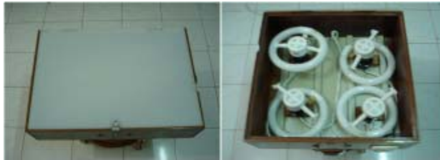
Gambar 1. Meja terang ( light table ) untuk identifikasi biji jagung QPM, terdiri atas kaca cendric dan empat lampu neon a 15 watt, diletakkan di bawah kaca.
