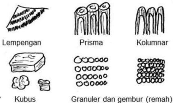
Gambar 14. Ilustrasi berbagai bentuk dari struktur tanah
