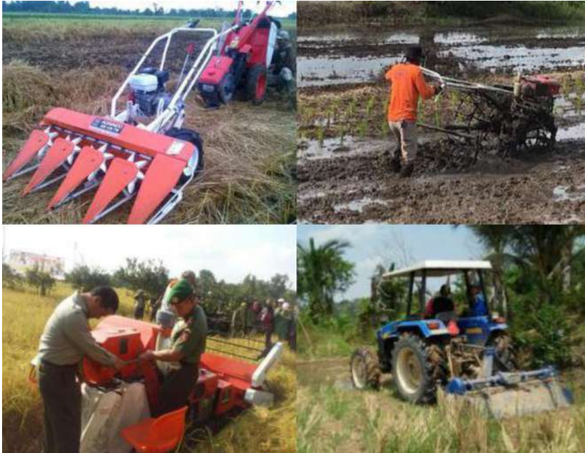
Gambar 3. Alsintan pendukung kegiatan optimalisasi lahan rawa, yaitu alat tanam (kiri atas), traktor roda 2 (kanan atas), alat panen (kiri bawah), dan traktor roda 4 -Jhon deer (kanan bawah)
