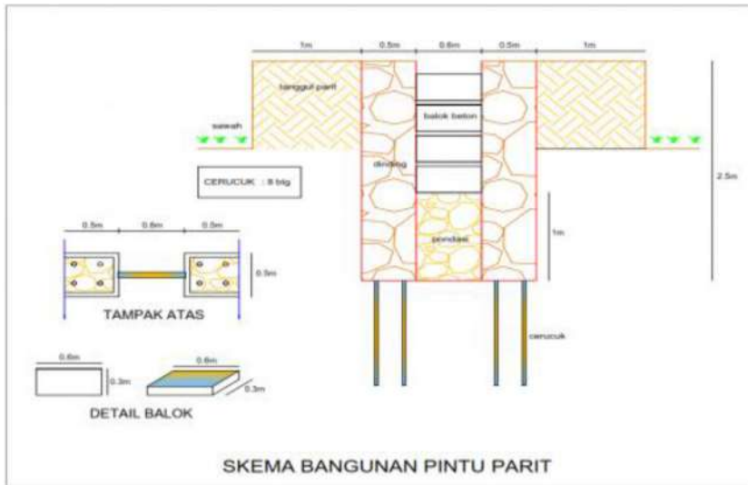
Gambar 7. Rancang-bangun pintu air/parit pada sistem polder Desa Pamalutan, Kabupaten Ogan Ilir, Sumatera Selatan
