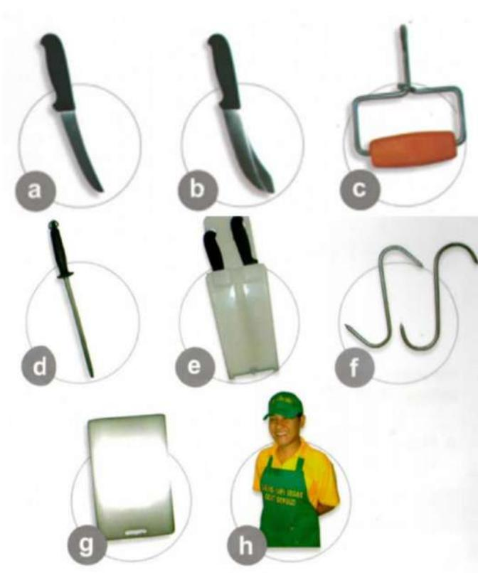
**Gambar 2.** Pisau *boning* (a); pisau *slicing* (b); pengait daging (*boning hook*) (c); *sharpening steel/crystal* (d); sarung pisau (*scabbard*) (e); gantungan daging (f); talenan (g), serta celemek (apron) dan topi (h)
