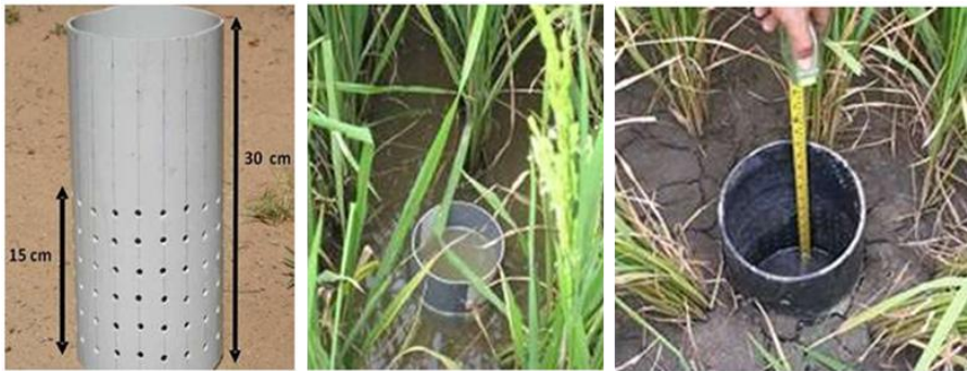
Gambar 25. Field Water Tube untuk monitoring ketinggian muka air tanah pada sistem AWD
