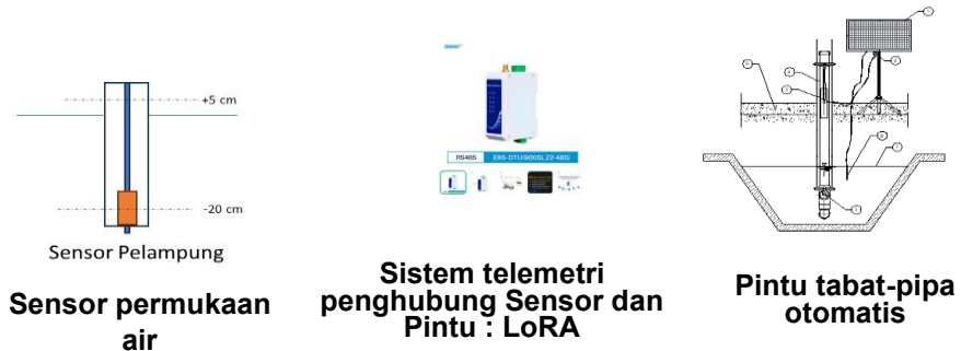
Gambar 23. Desain pintu air buka-tutup otomatis
