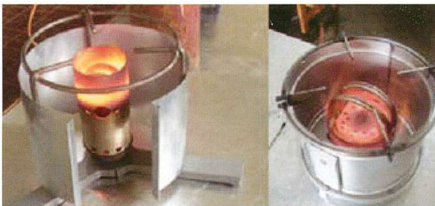
Gambar 6. Kompor model lama protos satu (a) dan kompor model baru protos dua (b).
