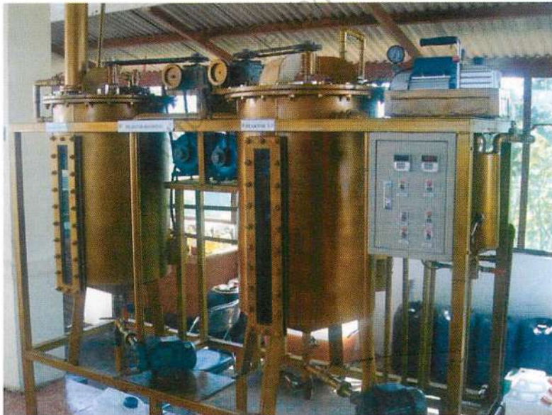
Gambar 4. Reaktor sederhana pembuat biodiesel dari minyak jarak pagar.
