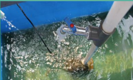
Posisi penempatan pompa akuarium dan keran pada semua model wolkaponik
