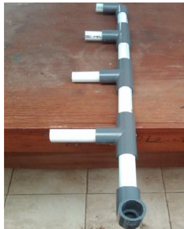
Rangkai pipa paralon yang dihubungkan dengan sambungan T dan L
