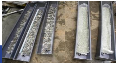
Kain kassa diletakkan di atas susunan zeolit besar
