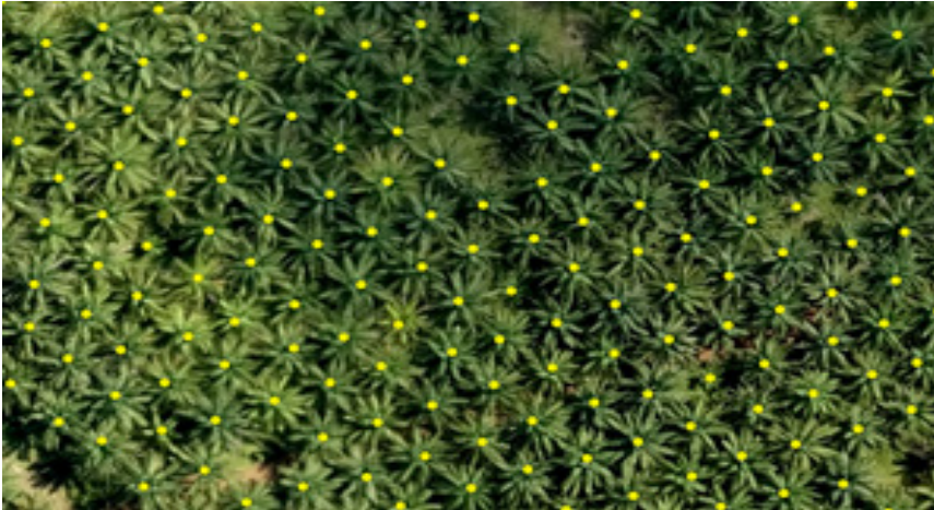
Gambar 5. Plant counting tanaman sawit pada perkebunan sawit menggunakan citra hasil pemetaan menggunakan fixed wing drone
