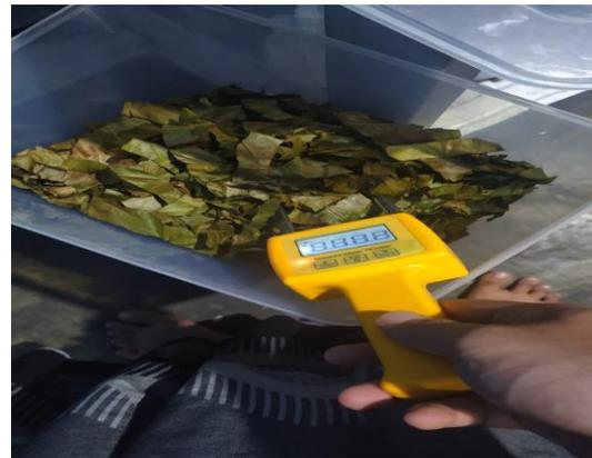
Gambar 10. Pengecekan Kadar Air
