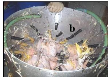
Proses pencabutan bulu di dalam drum *plucker*. Air dimasukkan ke dalam drum *plucker* untuk memudahkan pencabutan bulu
