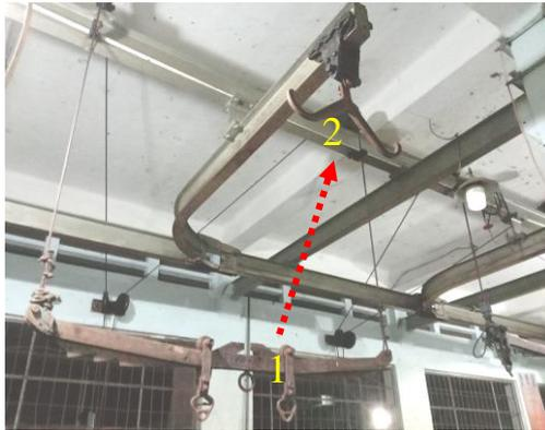
Target : memindahkan badan/karkas sapi dari posisi-1 (pada *stopper spreader*) ke posisi-2 (*hanger hook*) pada sistem rel dengan cara manual, tanpa listrik !
