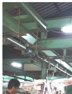
Gambar 165. Timbangan Karkas Di atas Rel WF atau Tube Rail
