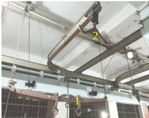
Gambar 152. Skema Penyelesaian Penyembelihan Memakai Sistem Rel Pada Lebih Dari 2 Titik Sembelih (b).
