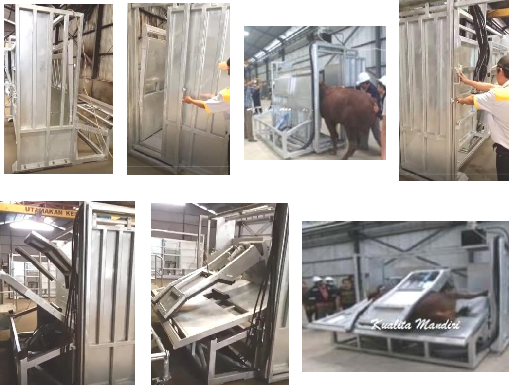
Gambar 104. Restraining Box Tipe Mark-4 KMA (Tanpa Pengekang Kepala).
