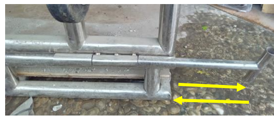
8. Frame dinamis dipasang atau dilepas pada frame penyangga memakai sistem engsel. Harus dengan ketepatan atau presisi yang tinggi.
