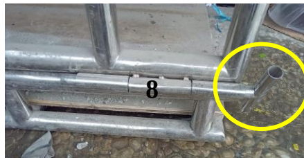
8. Frame dinamis dipasang atau dilepas pada frame penyangga memakai sistem engsel. Harus dengan ketepatan atau presisi yang tinggi.
