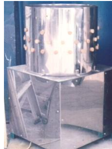
Plucker (MAS) : Dimensi total P x L x T = 80 x 80 x 70 cm, Drum berdiameter 60 cm dan tinggi 55 cm Kapasitas 15 ekor/proses, Motor 1,5 HP Rp 15.000.000,-/unit
