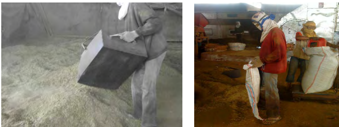
Gambar 8. Tepung gambir keluar dari mesin penggiling, ditimbang dan dipacking Sumber:: //repository.usu.ac.id
