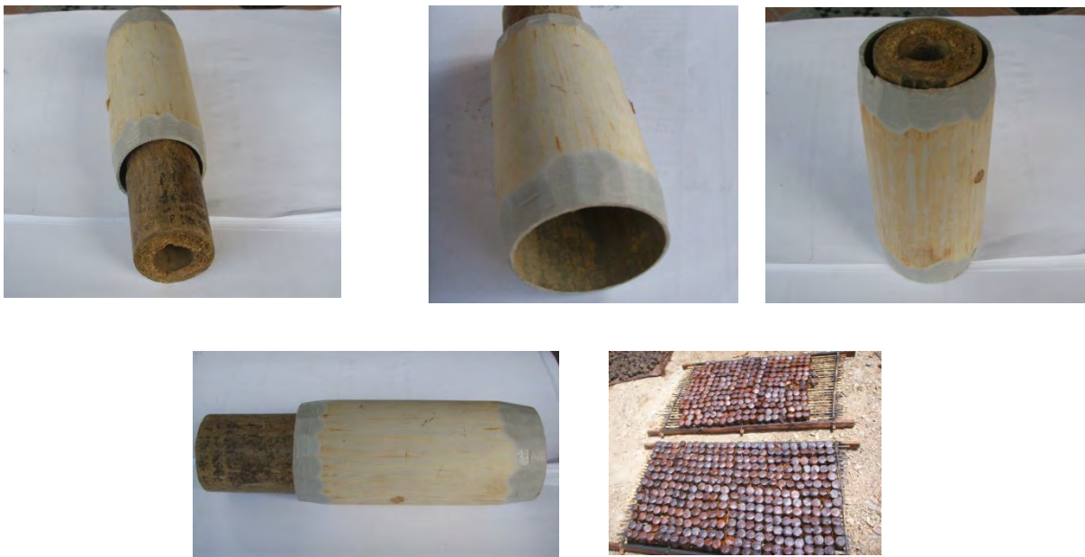
Gambar 3. Alat cetak gambir sederhana dan hasil cetakan
