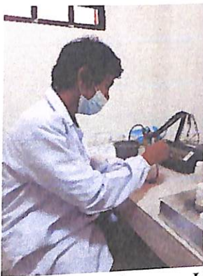
Gambar 61. Pengukuran pH tanah Sumber: Dokumentasi Pribadi
