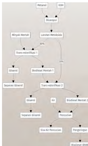
Gambar 24 Diagram alur proses pembuatan biodiesel
