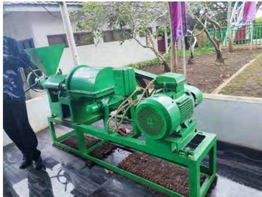
Gambar 20 Mesin single screw press untuk ekstraksi MKKS
