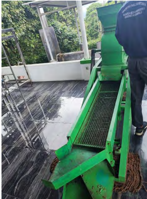
Gambar 16 Mesin decorticator untuk mengupas tempurung kemiri sunan
