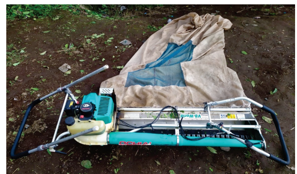
Gambar 1. Mesin pemetik daun teh model V8 NewZ2 merk Ochiai
