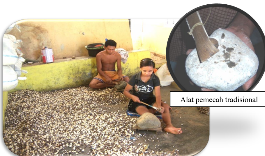
Gambar 6. Pemecahan Kemiri Alor dengan alat tradisional
