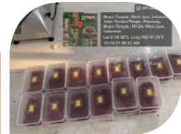
Prototipe Label Indikator untuk deteksi kesegaran daging
