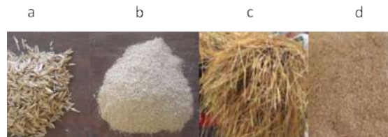
(a) Sekam dengan Tepungnya (b) dan Jerami (c) dengan Tepungnya d) Hasil Proses Penggilingan dengan Hammer Mill
