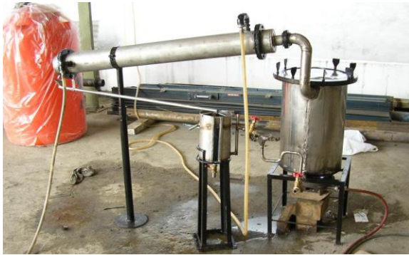
Gambar 27. Penyuling minyak atsiri berkapasitas 50 liter
