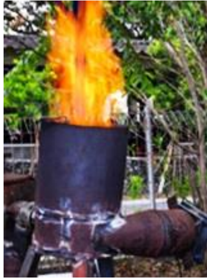
Gambar 1. Gas hasil downdraft gasifier pada penelitian oleh Puslitbang Perkebunan dan Fakultas Teknologi Pertanian UGM
