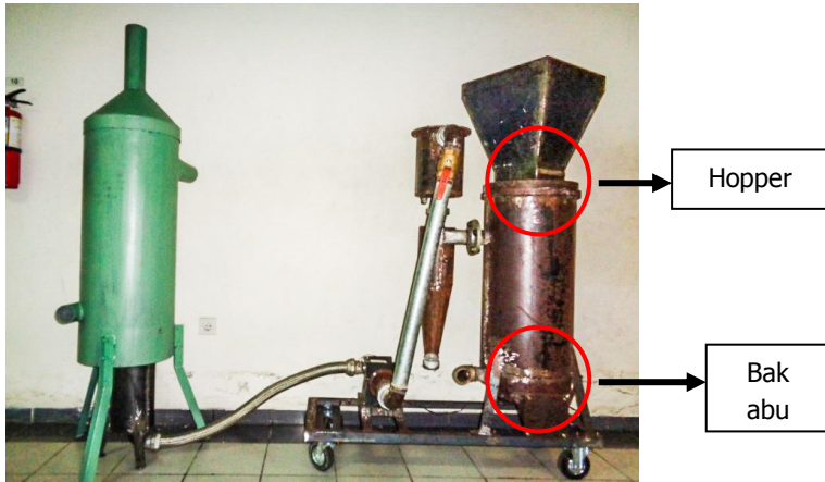
Gambar 21. Bagian-bagian gasifier yang harus menjadi perhatian kualitasnya
