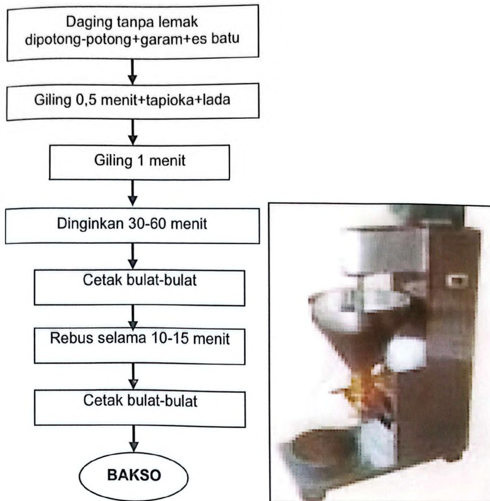
Gambar 8. Diagram alir pembuatan bakso dan mesin pencetak bakso.
