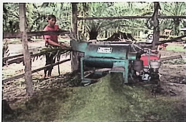
Gambar 1. Pencacahan pelepah dan daun kelapa sawit dengan mesin Chopper
