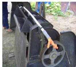
Gambar 1. Tipe dekortikator yang tersedia di daerah pengembangan rami
