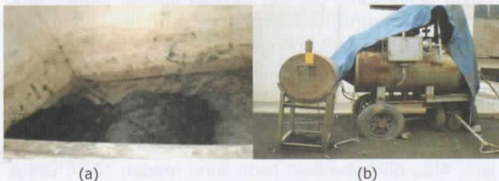
Gambar 8. Sterilisasi Media tanam (a) menggunakan Steam Boiler (b).
