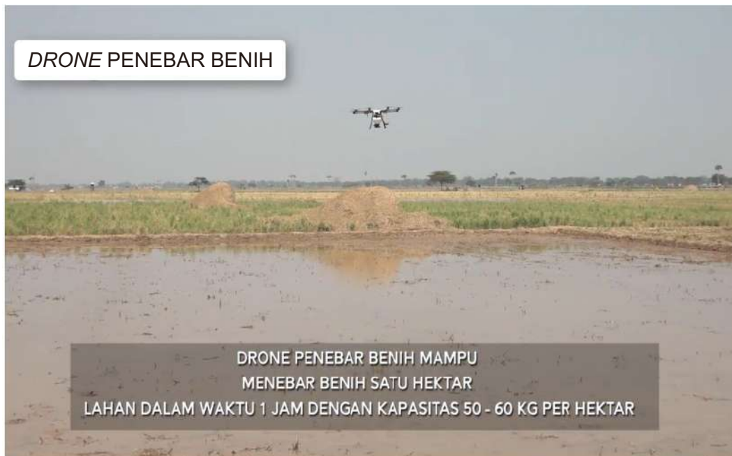
Gambar 4.9. Drone Penebar Benih dengan Kapasitas 50-60 kg/ha
