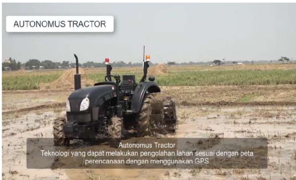
Gambar 4.8. Autonomus Tractor , Pengolahan Lahan Menggunakan GPS
