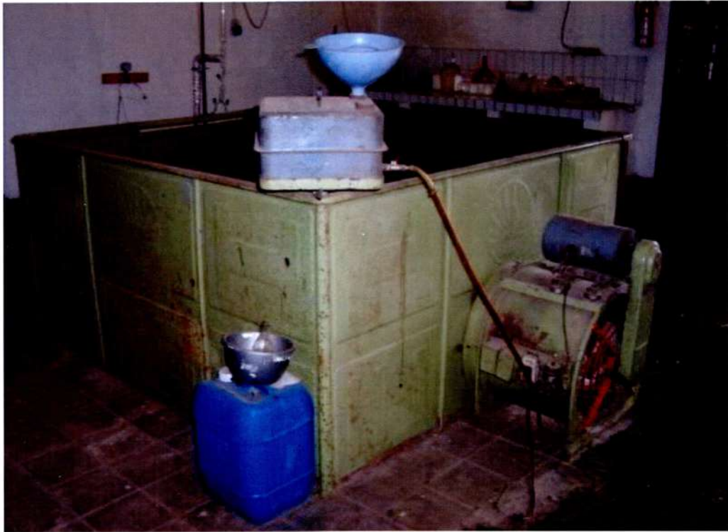
Gambar 3. Contoh alat pengering aliran udara panas dengan tenaga listrik (Foto: Ma'mun, 2006).
