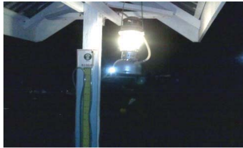
Gambar 10.11. Gas-bio sebagai bahan bakar untuk penerangan
