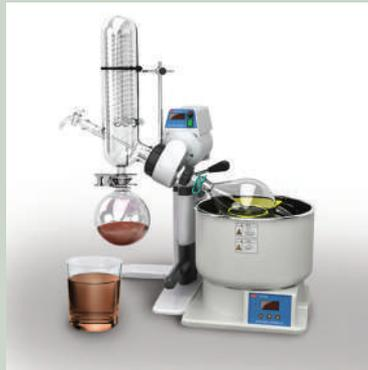
j. Uapkan ekstrak vanili menggunakan *rotary vacuum evaporator* bersuhu 40 °C dan kecepatan 150 rpm selama 3 jam. Setelah penguapan, 300 ml ekstrak vanili menjadi 160–170 ml berkadar vanilin 3,74%.\*\*\*
