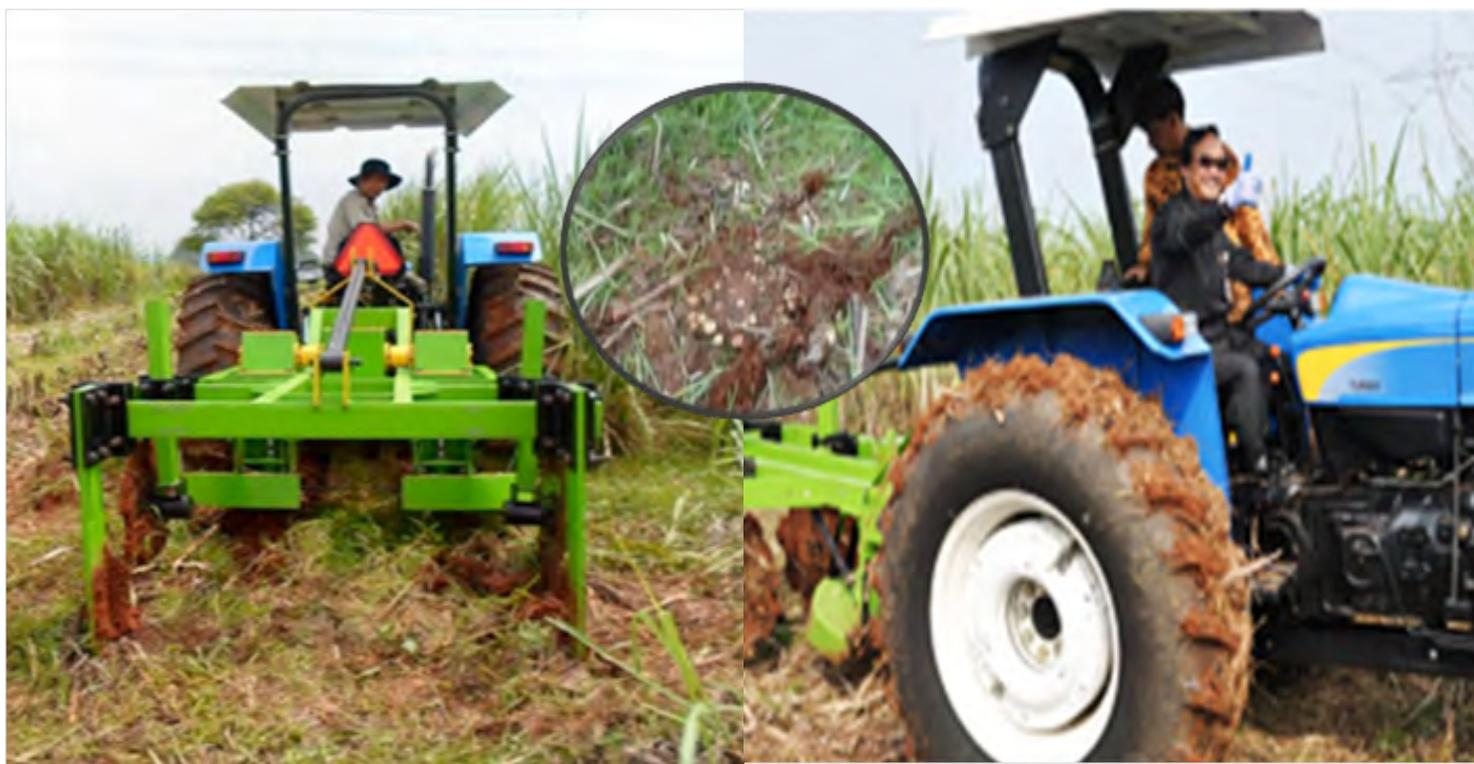
Gambar 32 . Mesin Pengepras Tebu
