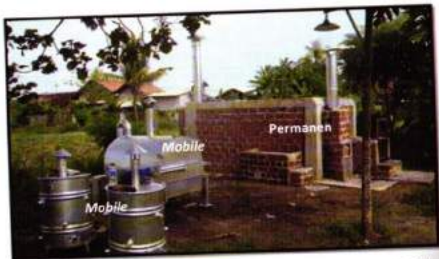
Gambar 3. Alat pembuat biochar (pirolisator) mobile dan permanen di Kebun Percobaan Taman Bogo, Lampung (Foto: Nurida)
