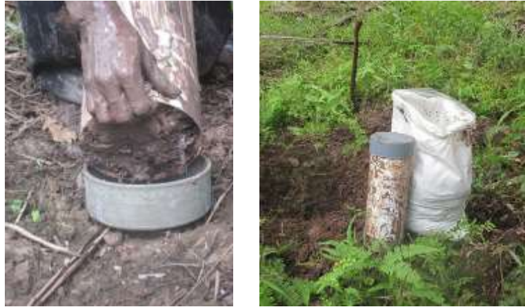
Gambar 8. Pengambilan contoh tanah utuh (Foto: Imam Purwanto)
