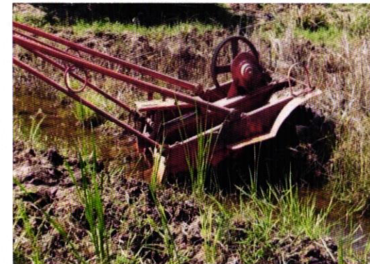
Gambar 7. Pengolahan tanah ringan dengan rotary traktor kura- kura (Foto: Rahmat Hidayat)
