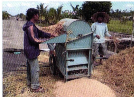
Gambar 29. Prosesing perontokan gabah dengan menggunakan alat perontok ( pedal thresher ) (Foto: Sukristiyonubowo)
