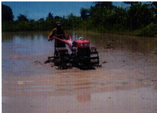
Gambar 6. Pengolahan tanah dengan rotary hand tractor (Foto: Didik S.Hastono)
