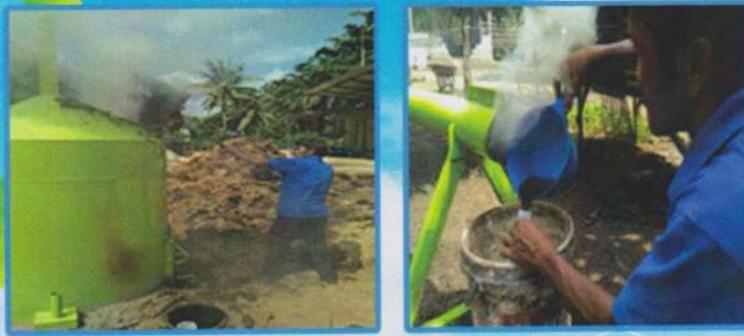
Gambar 2. Proses pembuatan asap cair yang menghasilkan asap cair berwarna keruh
