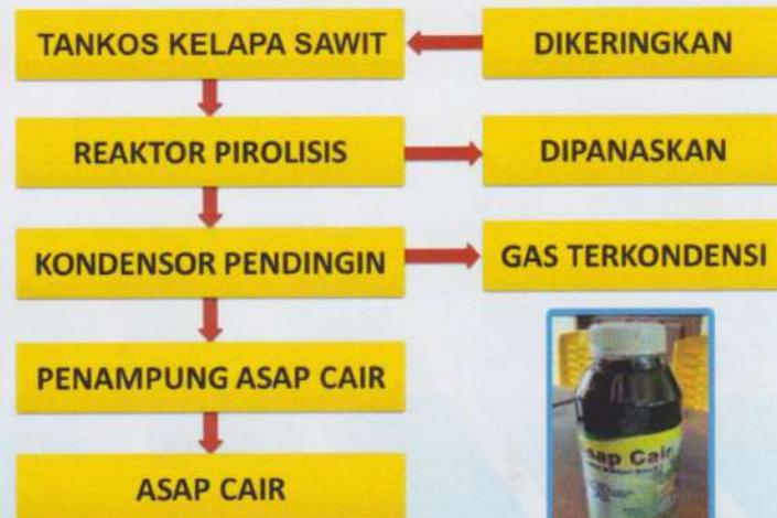
Gambar 1. Proses pembuatan asap cair
