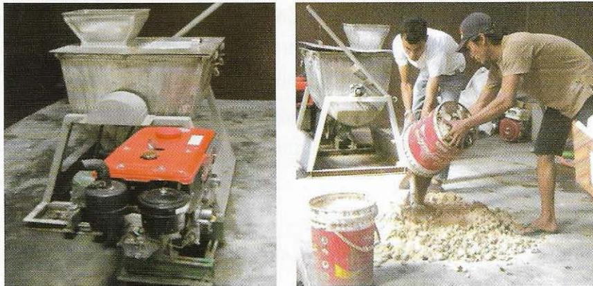
Gambar 9. Alat mesin pengaduk (*mixer*) *complete feed*
