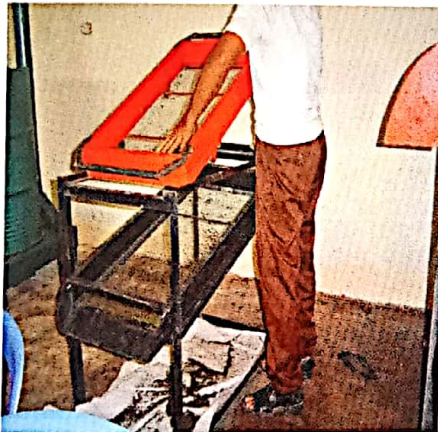
Sortasi buah segar untuk memisahkan buah yang kecil (menir) dan kotoran lain
