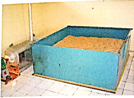
Pengeringan dengan alat pengering mekanis ( 50-60°C untuk 5-6 jam )
