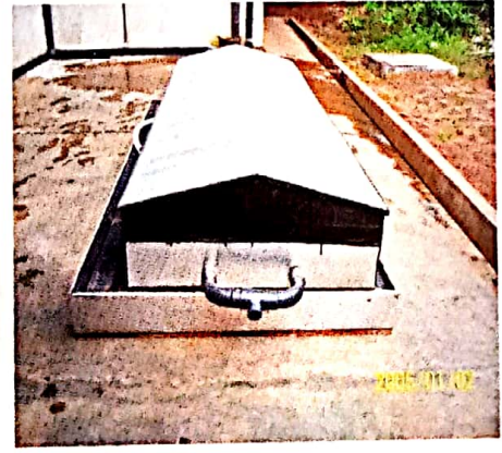
Alat pengering tenaga surya
