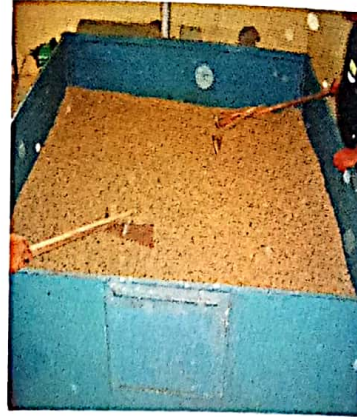
Proses pembalikan untuk memperoleh produk kering yang seragam
