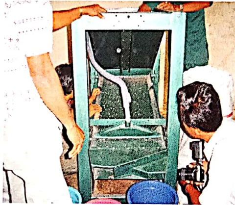
Proses sortasi untuk memisahkan lada enteng, aval, dll
