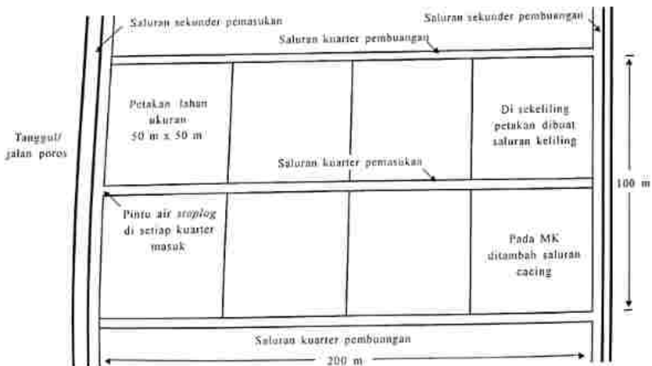
Gambar 1. Penataan lahan untuk luasan 2 ha (satu paket pemilikan) dengan penerapan sistem tata air mikro dalam usaha tani lahan pasang surut (Proyek Penelitian Pengembangan Pertanian Rawa Terpadu-ISDP 2000)
