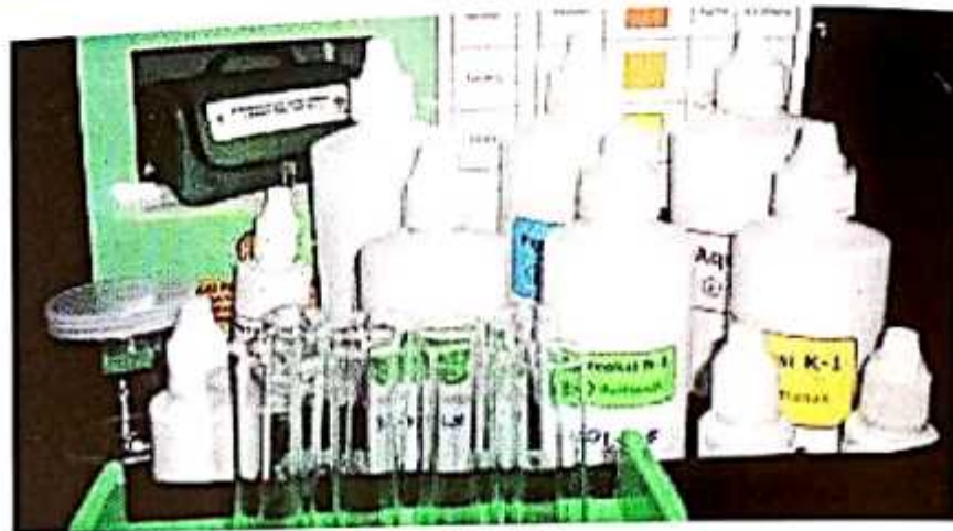
Gambar 8. Perangkat Uji Tanah Sawah (PUTS) untuk penentuan pemupukan padi sawah
