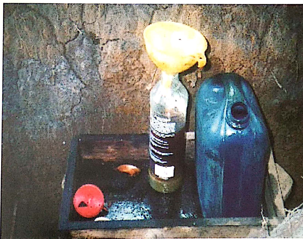
Gambar 8. Minyak nilam berwarna gelap (kotor) hasil penyulingan tingkat petani (plat besi/drum bekas)
