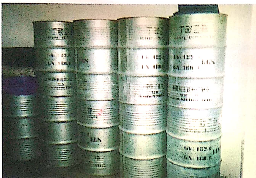
Gambar 5 Pengemasan minyak nilam dalam drum yang bagian dalamnya dilapisi dengan timah putih (galvanis) untuk tujuan ekspor
