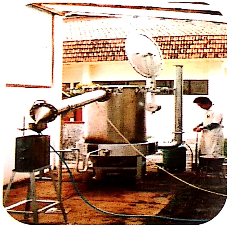
Gambar 2. Alat penyuling minyak atsiri (nilam) hemat energi rancangan Balitro dan Balai Besar Litbang Pascapanen Pertanian yang sedang dioperasikan
