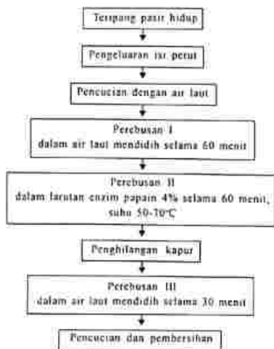
Gambar 1. Diagram alir proses penghilangan lapisan kapur pada teripang pasir
