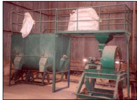
Satu unit peralatan prosesing untuk pembuatan Complete Feed skala menengah dengan kapasitas 20-30 ton/hari.
