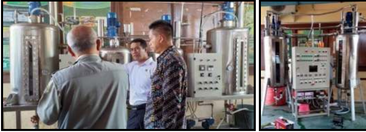
Gambar 26. Kiri: Reaktor multifungsi dengan Sistem Metanol Recovery untuk membuat biodiesel/B100 rekayasa Kementan di Instalasi Bioenergi di Pakuwon; Kanan: Mentan RI saat meninjau pengembangan biodiesel 100% (B100) di Balai Penelitian Tanaman Industri dan Penyegar (Balittri, Sukabumi)
