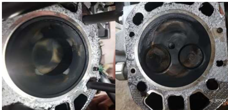
Gambar 40. Hasil jelaga pada silinder head dan torak/piston
