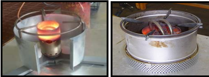
Gambar 24. Kompor tekan dengan bahan bakar minyak nabati (CPO, minyak kelapa dll), tipe lama (a), dan tipe baru (b)
