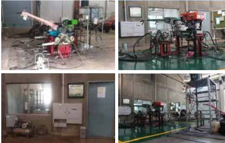
Gambar 38. Test rig untuk uji power pada poros traktor roda 4 dan uji konsumsi bahan bakar
