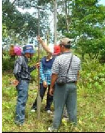
Gambar 4. Pengukuran kedalaman dan pengambilan contoh gambut dengan menggunakan bor gambut
