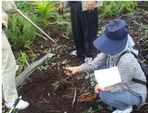
Gambar 5. Penentuan kematangan gambut (fibrik, hemik, saprik) dengan cara meremas tanah gambut
