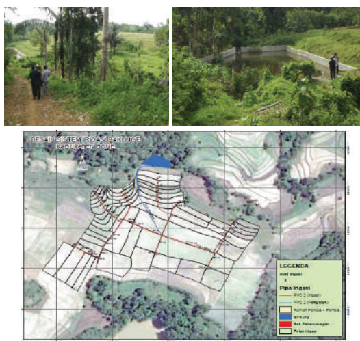
Gambar 9. Pemanfaatan Sumber Air Embung untuk Sawah Tadah Hujan di Desa Mappasangkae, Kecamatan Ponro, Kabupaten Bone.
