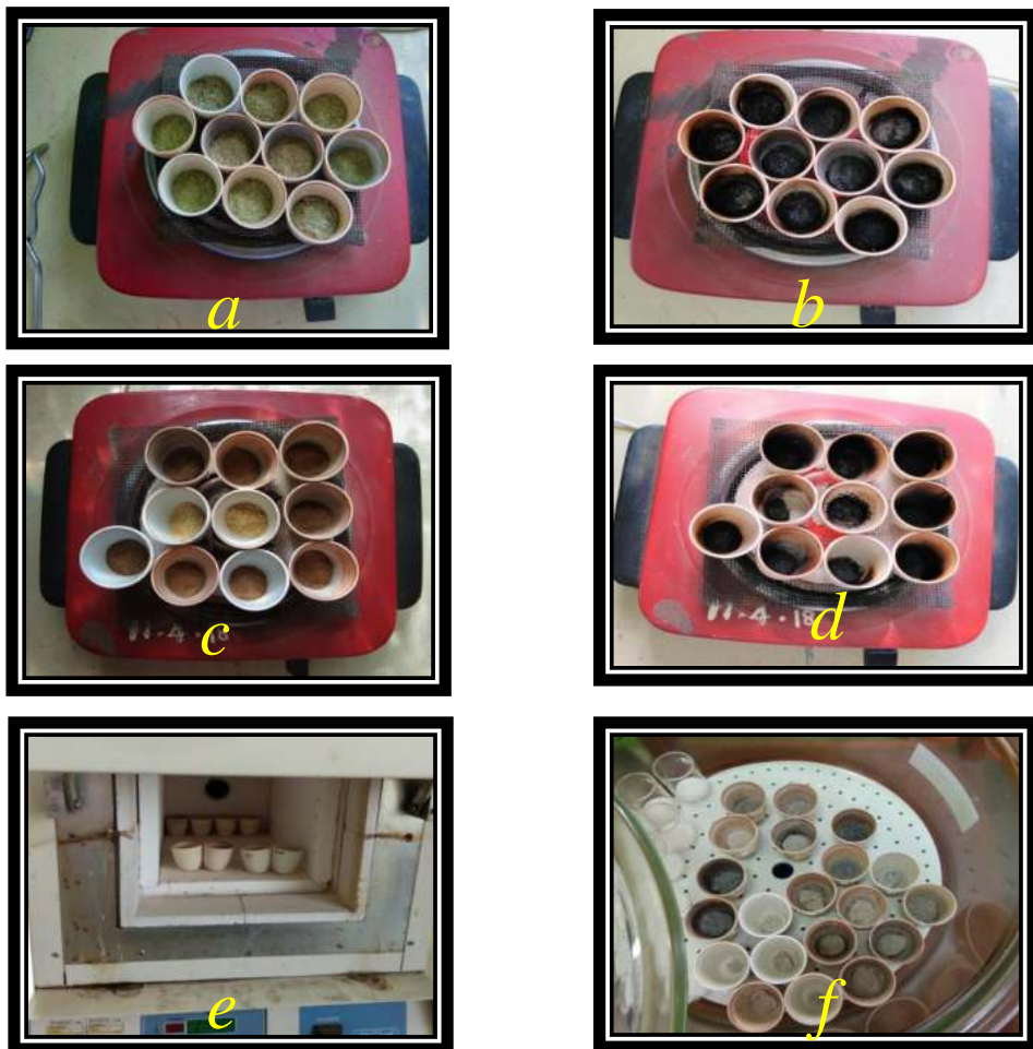
Gambar 1. Hijauan sebelum pengarangan (a), hijauan setelah pengarangan (b), konsentrat sebelum pengarangan (c), konsentrat setelah pengarangan (d), pengabuan tanur (e), abu sampel setelah tanur (f).
